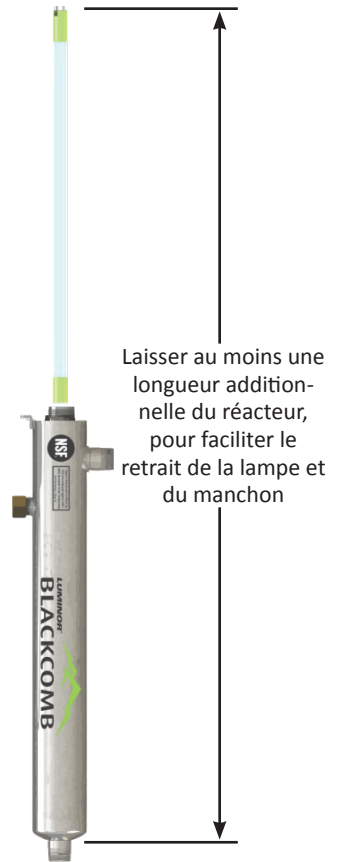
Figure 2. Espace requis pour enlèvement de la lampe
