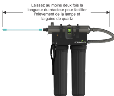
Figure 3. Espacement requis pour enlèvement de la lampe
