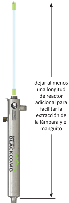
Fig. 2. Espacio para reemplazar la lámpara
